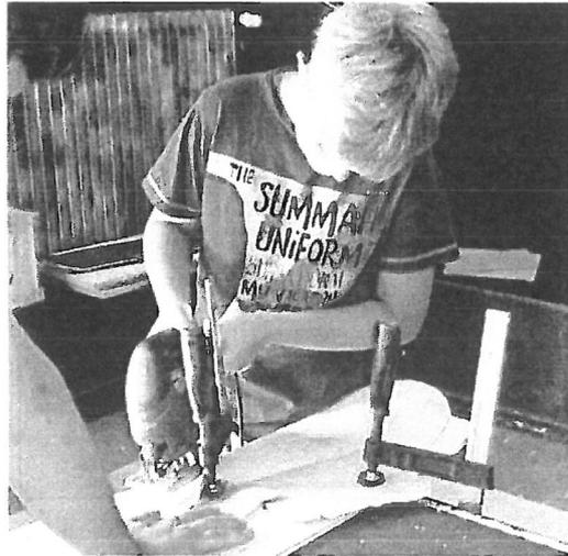
Nach dem Zuschneiden werden die Holz furniere miteinander verleimt, gepresst und dann die endgültige Form ausgesägt. Foto: Jugendzentrum
